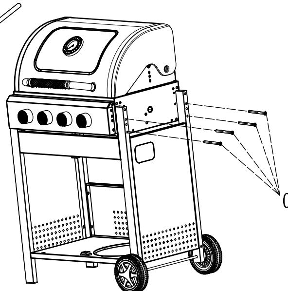
DK Monter de højre ben (16A, 16B) på højre side af grillenheden (1) med 4 skruer (C).
