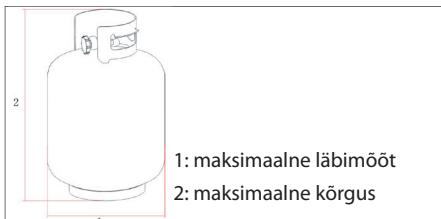
Gaasivoolik peab olema maksimaalselt kuni 150 cm pikk ning varustatud heaksiidetud regulaatoriga vastavalt standardile EN 16129:2013 (kuulub komplekti).
