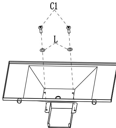
DK Monter dryppskålholderen (23) på drypbakken (22) oppefra med 2 skruer (C1+L).
