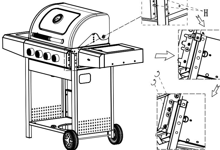
DK Skru 2 skruer (H) ind i hullerne i højre side af betjeningspanelet på grillenheden (1). Sæt det højre sidebord (20) ind over de 2 skruer, og stram skruerne.
