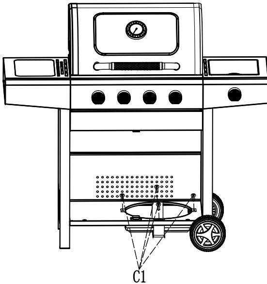
DK Monter beslag (31+32) til gasfl asken med skruer (C1).
