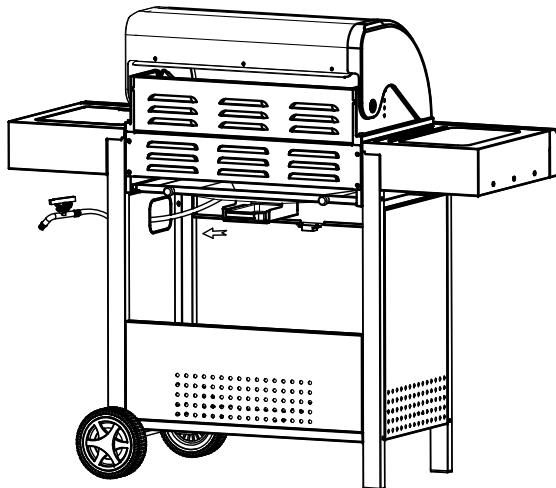
DK Træk slangen til sidebrænderen ud gennem hullet i højre sideplade.
