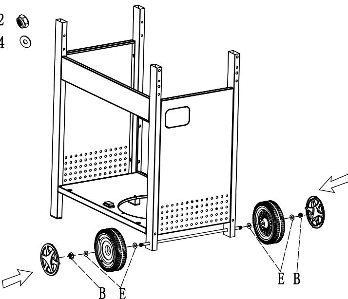
DK Sæt hjulakslen (14) ind gennem hullerne nederst på de højre ben (16A, 16B). Sæt en skive (E), et hjul (12), en skive (E) og en møtrik (B) på hver ende af akslen og spænd fra begge sider. Monter til slut hjulkapsler (13) ved at trykke dem på.
