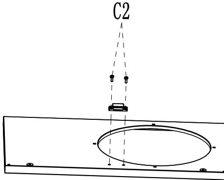
DK Monter dørmagnet (11) med skruer (C2) på bundpladen (30)
